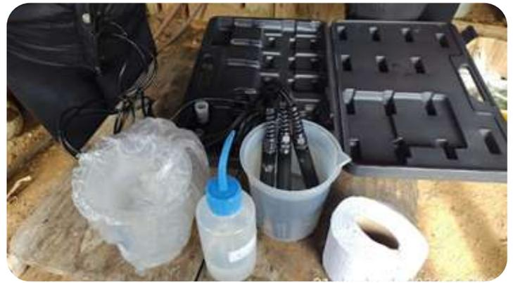
Medição de parâmetros físico químicos “in loco” pela equipe: turbidez, pH, oxigênio dissolvido, condutividade, temperatura, cloreto, nitrito, nitrato, cloro livre e alcalinidade
